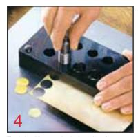
Tenir le découpoir droit et l'enfoncer jusqu'à la plaque à emboutir en le tournant légèrement de droite à gauche et inversement.
