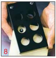
La plaque est centrée par le cône. Poser la partie supérieure de manière parallèle. Pour contrôler le centrage, regarder par dessous en maintenant le centreur en position.
