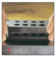
Une plaque de travail plane en acier trempé, d'env. 300x300x40mm, tel est l'idéal pour un travail parfait. Chaque outil A,Z&F comprend une partie supérieure et une partie inférieure. Soulever parallèlement la partie supérieure...
