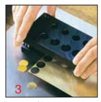
La partie supérieure est descendue jusqu'à la plaque à emboutir en veillant à la maintenir parallèle.
