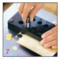
La partie supérieure est posée de manière parallèle à 1mm environ de la plaque à emboutir. Tenir le centreur droit et l'enfoncer jusqu'à la plaque à emboutir en le tournant légèrement de droite à gauche et inversement.
